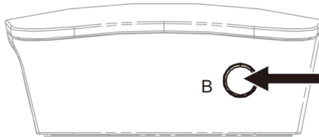
Connect 上面の MEE audio のロゴに対して左下にある LED インジケーターが青く点滅し Connect がペアリングモードになったことを知らせます。
