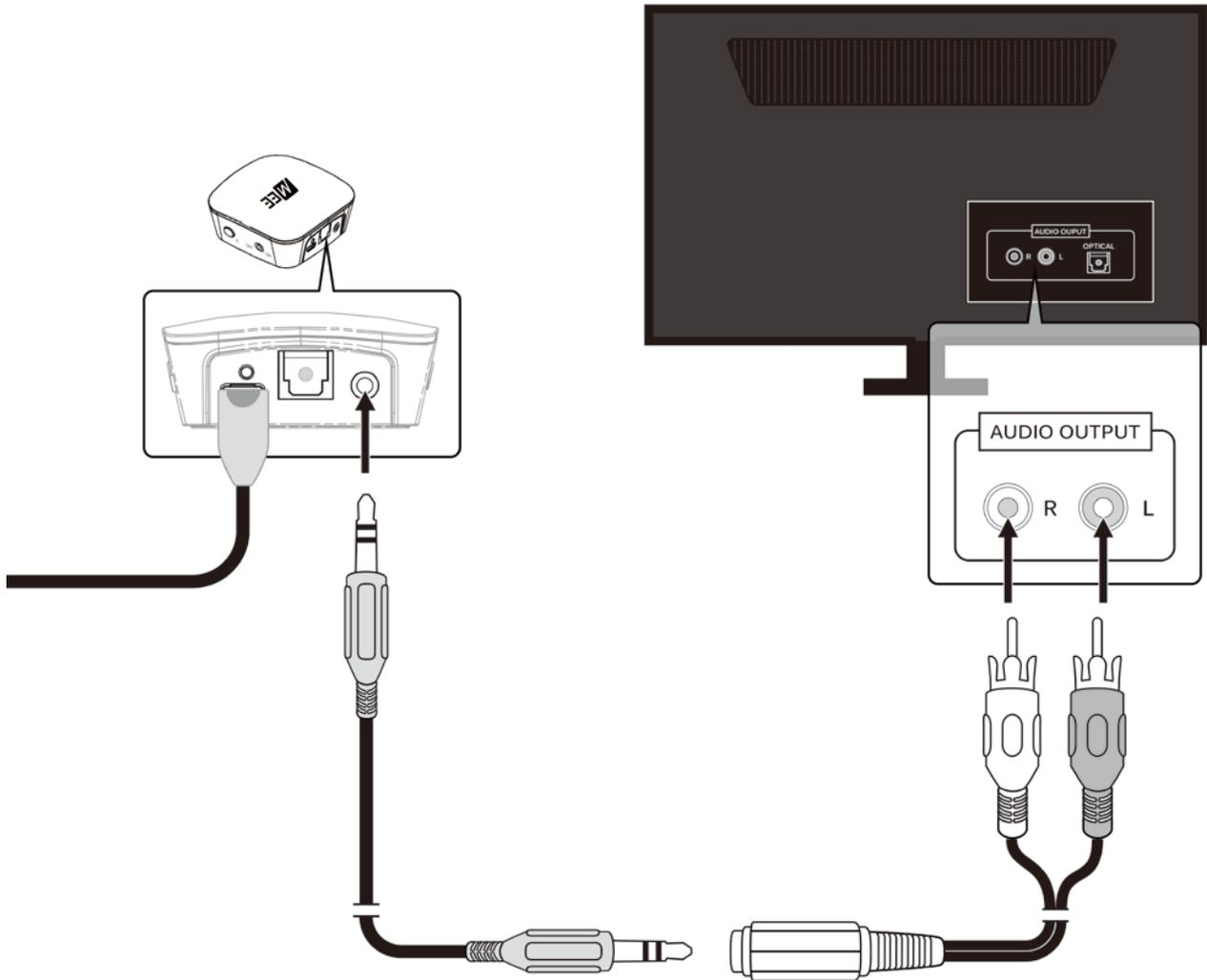
本パッケージに付属の 3.5mm ステレオミニオーディオケーブルと RCA アダプターを用意します。ステレオミニケーブルを Connect 本体とアダプターに接続し、RCA アダプターの赤色及び白色の各端子をテレビ等の機器のオーディオ出力端子に接続します。ペアリングしたヘッドホンやスピーカーからテレビのサウンドが聴こえれば接続は完了です。
